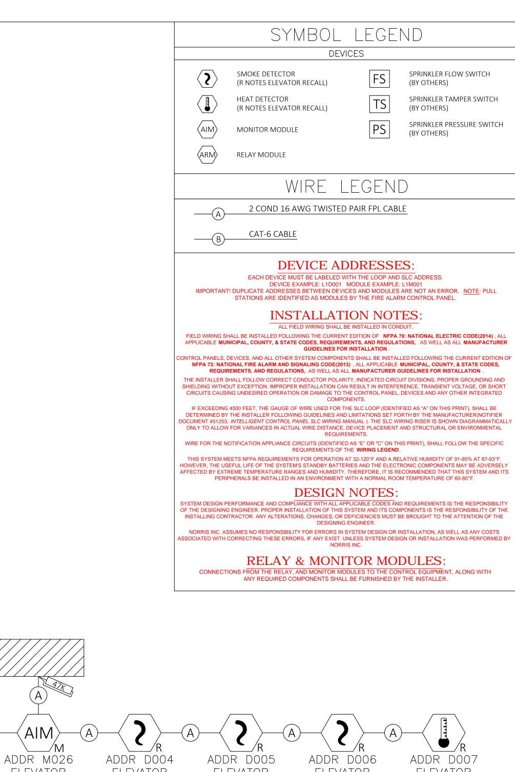
ELEVATOR SHUNT TRIP MONITOR
