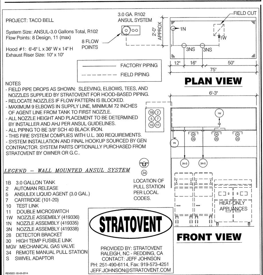
TACO BELL HOOD FIRE SUPPRESSION SYSTEM PLAN N.T.S.
