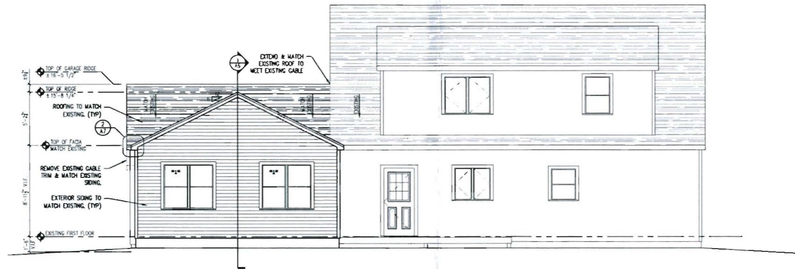
2 EAST ELEVATION A5 SCALE: 1/4" = 1'-0"
