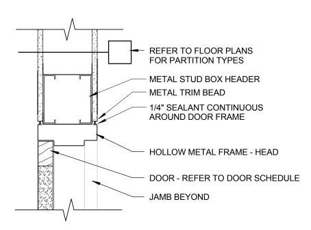
4 FLUSH HOLLOW METAL FRAME - DOOR HEAD
