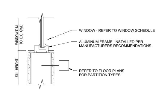
METAL STUD WALL WINDOW SILL DETAIL
