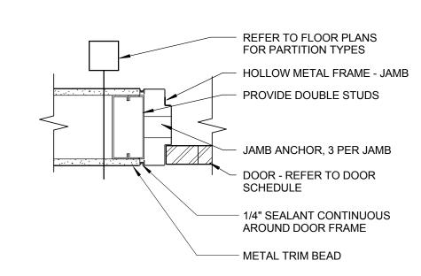
5 FLUSH HOLLOW METAL FRAME - DOOR JAMB
