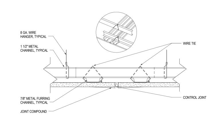
8 SUSPENDED GYPSUM BOARD CEILING CONTROL JOINT DETAIL
