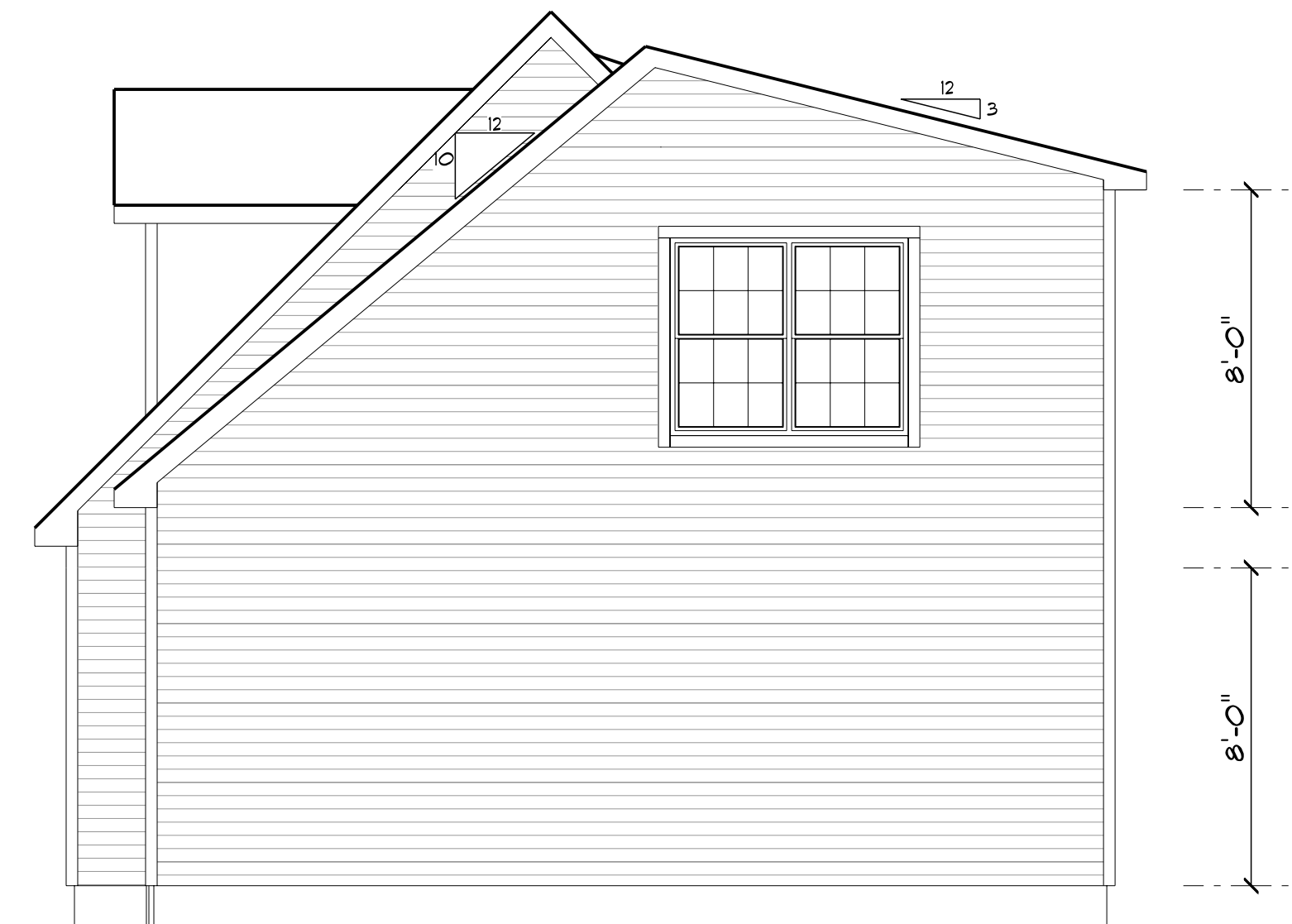
RIGHT ELEVATION SCALE: 1/4" = 1'-0"
