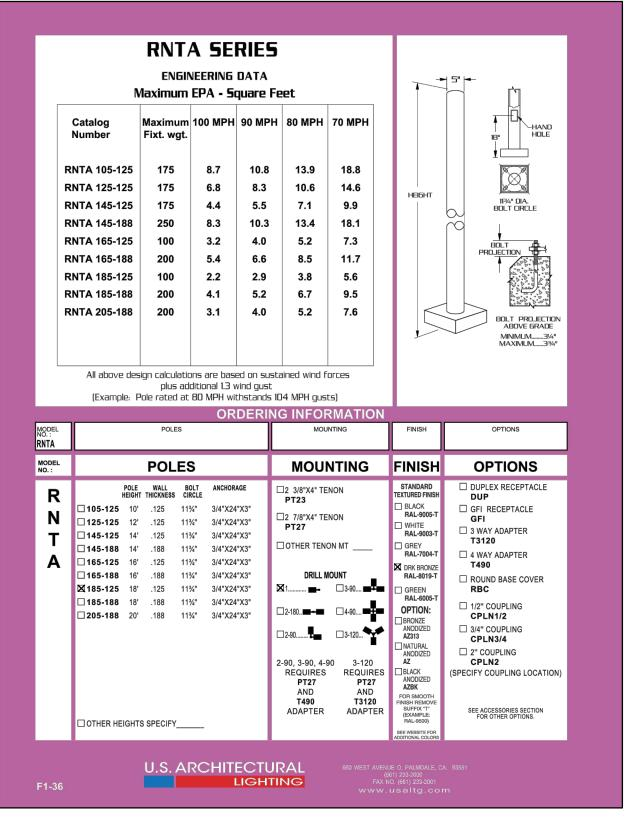
ROUND POLE TYPICAL FOR VP-A3, VP-A4, VP-S4, & VP-A5
