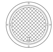
HATCH (Ø36" CAST INTO SLAB) N.T.S.
