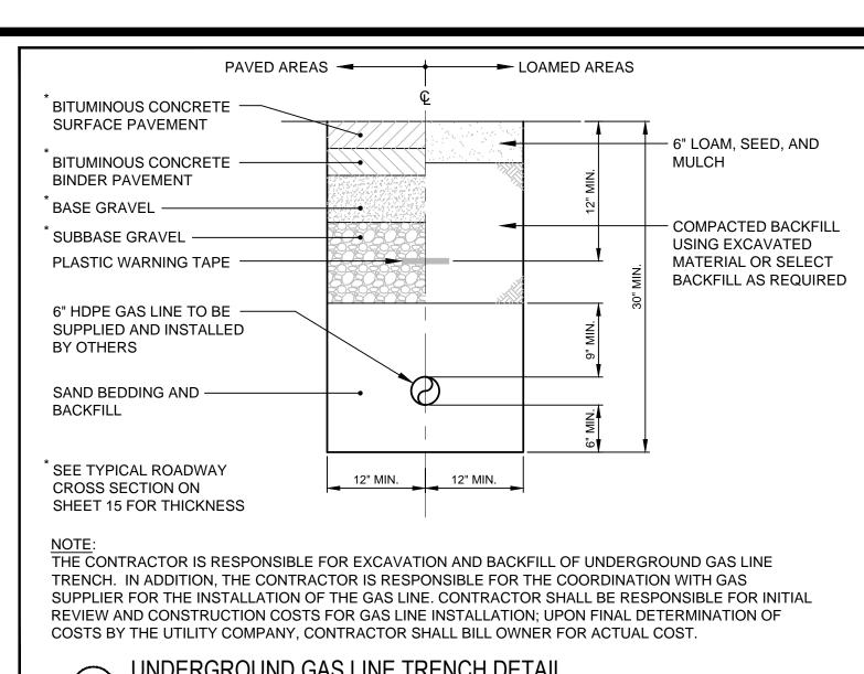
UNDERGROUND GAS LINE TRENCH DETAIL
