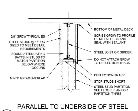
B3 JOIST OR JOIST GIRDER
