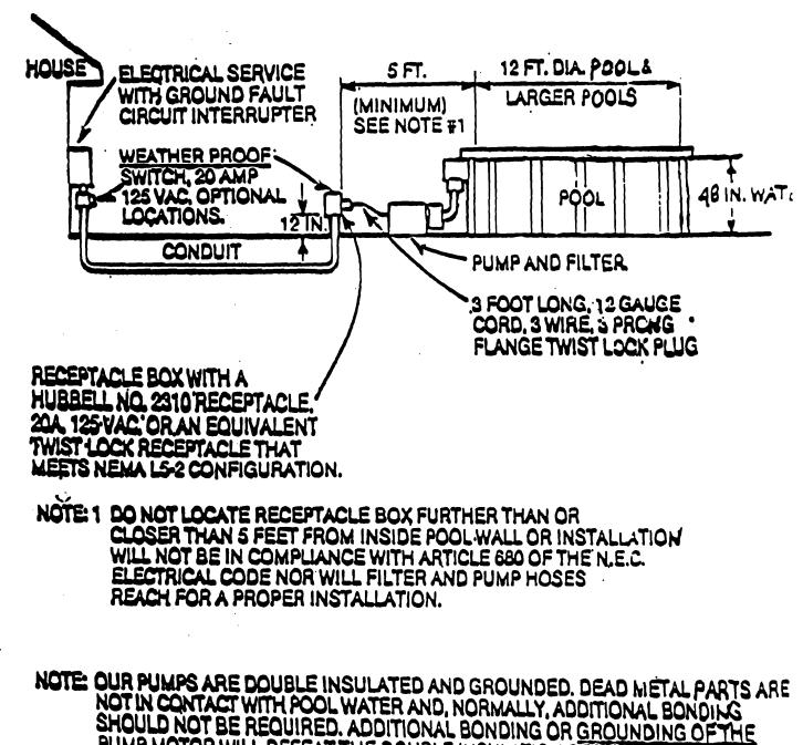
PUMP MOTOR WILL DEFEAT THE DOUBLE INSULATION DESIGN.
