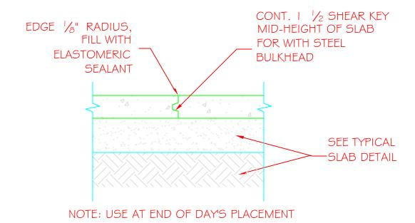
3 TYPICAL SLAB CONSTRUCTION JOINT DETAIL
