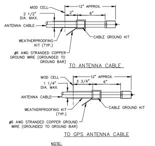
1 DO NOT INSTALL CABLE GROUND KIT AT A BEND AND ALWAYS DIRECT GROUND WIRE DOWN TO GROUND BAR.
