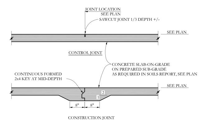
TYPICAL JOINTS AT INTERIOR SLAB-ON-GRADE
