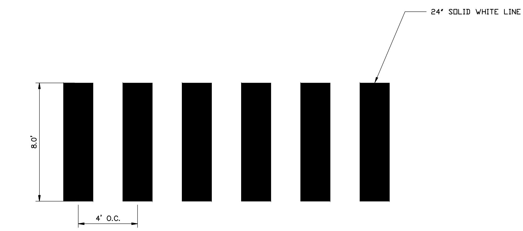
CROSSWALK WITH LONGITUDINAL LINES N.T.S.
