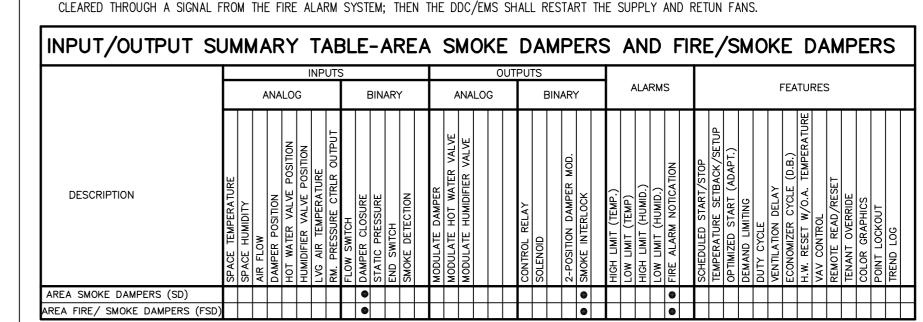
AREA SMOKE AND FIRE/SMOKE DAMPERS CONTROL SCHEMATIC
