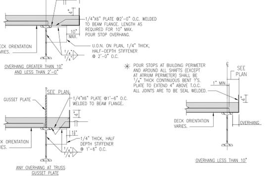
TS-20 TYPICAL SLAB EDGE SUPPORT DETAIL
