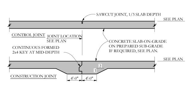
TYPICAL JOINTS AT INTERIOR SLAB-ON-GRADE
