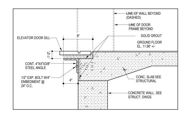
2 ELEVATORS - SILL DETAIL AT GROUND FLOOR
