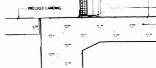
5 SILL DTL - DOORS 111, 117 A-201 Scale: 1 1/2" = 1'-0"
