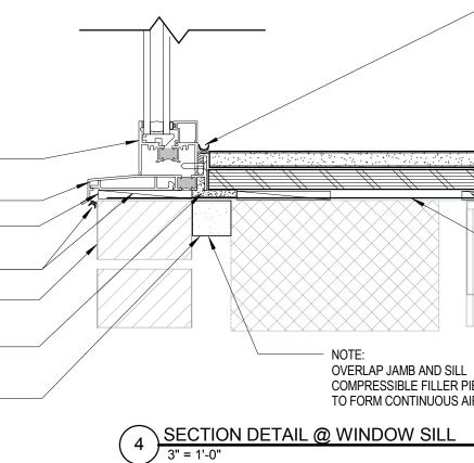
WINDOW FRAME SEAL ENDS OF SILL EXTRUSION PROIR TO INSTALLATION SOLID PLASTIC SHIMS SEALANT AT EXPOSED EDGE & IN SHIM SPACE BELOW SILL EXTRUSION EX'G BRICK VENEER
