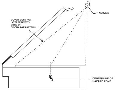
THE NOZZLE IS TO BE PLACED TOWARD THE FRONT OF THE APPLIANCE TO MINIMIZE THE POTENTIAL FOR THE SKILLET OR BRAISING PAN COVER TO INTERFERE WITH THE NOZZLE DISCHARGE.
