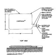
(8) DIRTBAG PUMPED SILT CONTROL SYSTEM
