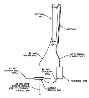
TYPICAL ANTENNA **GROUNDING DETAIL**
