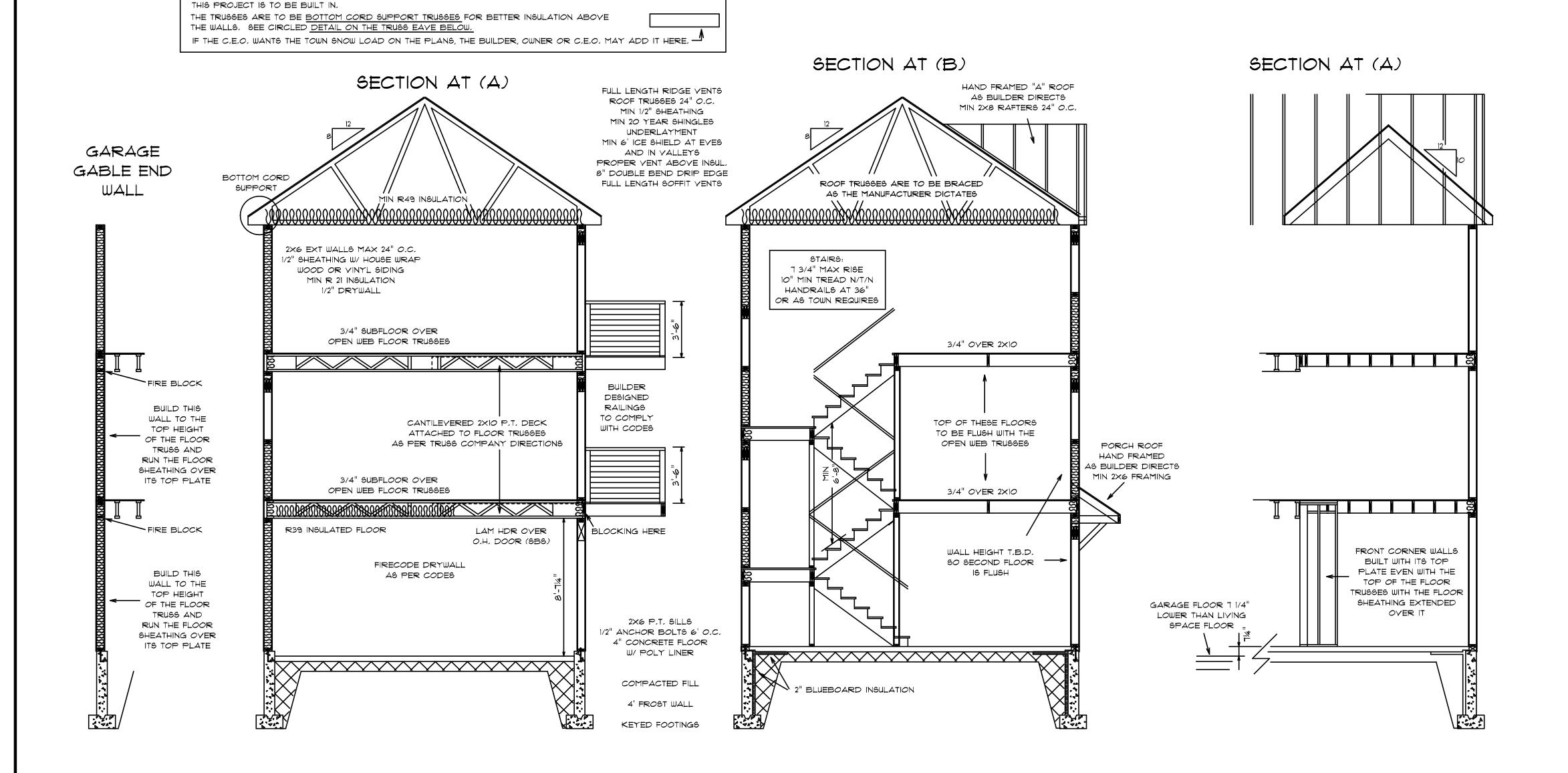
EAVE & WALL SECTION - FACTORY TRUSSES RIDGE VENT MIN 1/2" SHEATHING W/ CLIPS MIN 20 YEAR SHINGLES 6' ICE & WATER SHIELD APPLIED ON TOP OF DRIP EDGE USE CANTILEYER PROPER YENT STYLE TRUSS RECOMMEND DOUBLE BEND DRIP EDGE-SIMPSON TRUSS STRAPS PINE FASCIA AND SHADOW BOARD 1111111111 - 1 MIN R 49 INSULATION 2×6 SUB FASCIA YENTED SOFFIT 1/X3 STRAPPING AND 1/2" DRYWALL 2×6 WALLS 16" O.C. — 1/2" SHEATHING MIN (3) 2×10 HEADERS WOOD OR UNLESS SPECIFIED DIFFERENTLY YINYL SIDING R-21 INSULATION ---->
