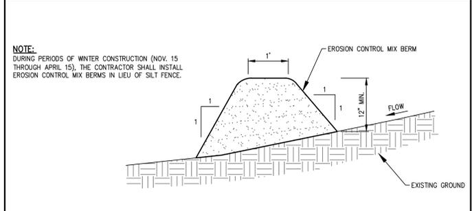
**EROSION CONTROL MIX BERM DETAIL**
