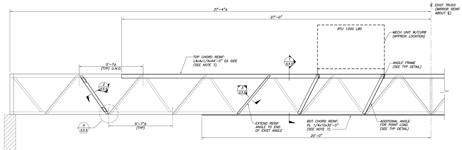
EXIST JOIST REINFORCING ELEVATION (JOISTS @ MECH UNITS)
