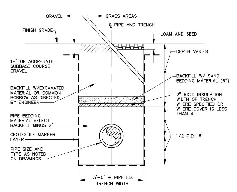
1. SAND BACKFILL AND RIGID INSULATION AS REQUIRED.
