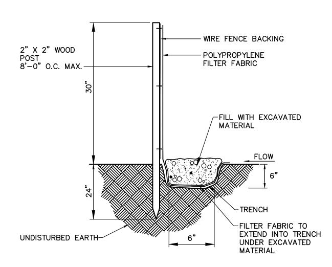
EROSION CONTROL FENCE DETAIL
