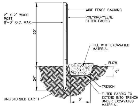
**5 EROSION CONTROL FENCE DETAIL**
