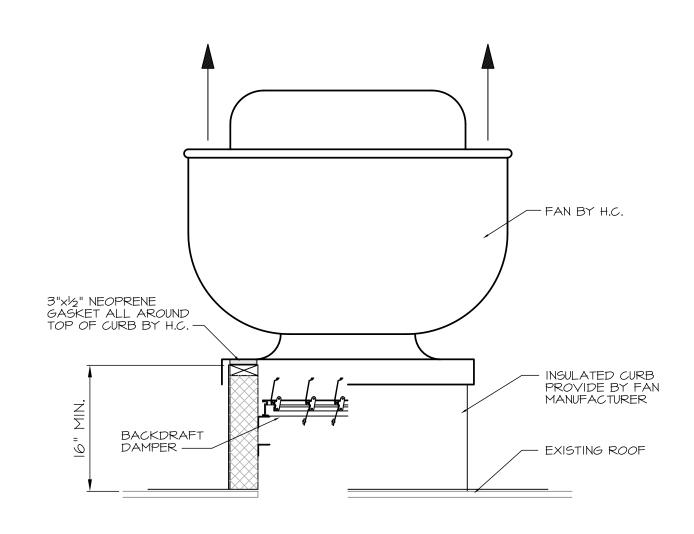
(5) <u>exhaust fan detail</u> NO SCALE
