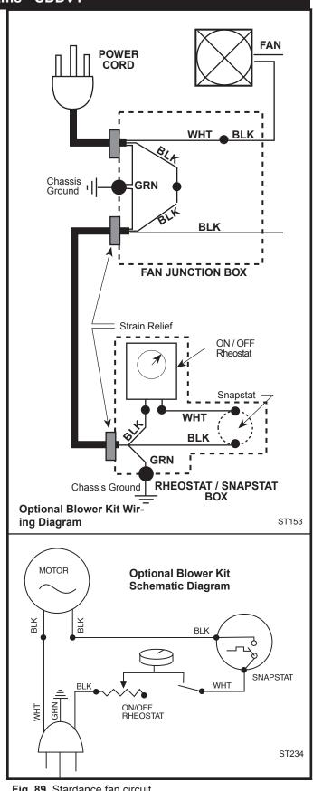
Fig. 89 Stardance fan circuit.
