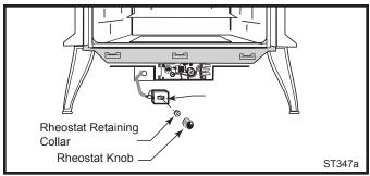
Fig. 17 Attach the fan rheostat.
