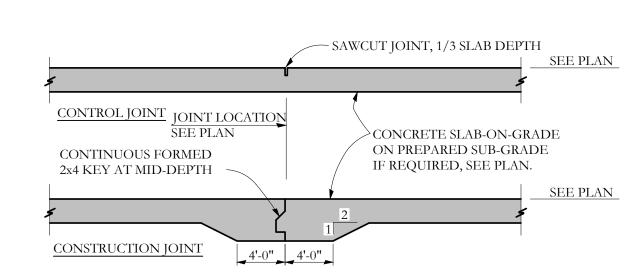
TYPICAL JOINTS AT INTERIOR SLAB-ON-GRADE
