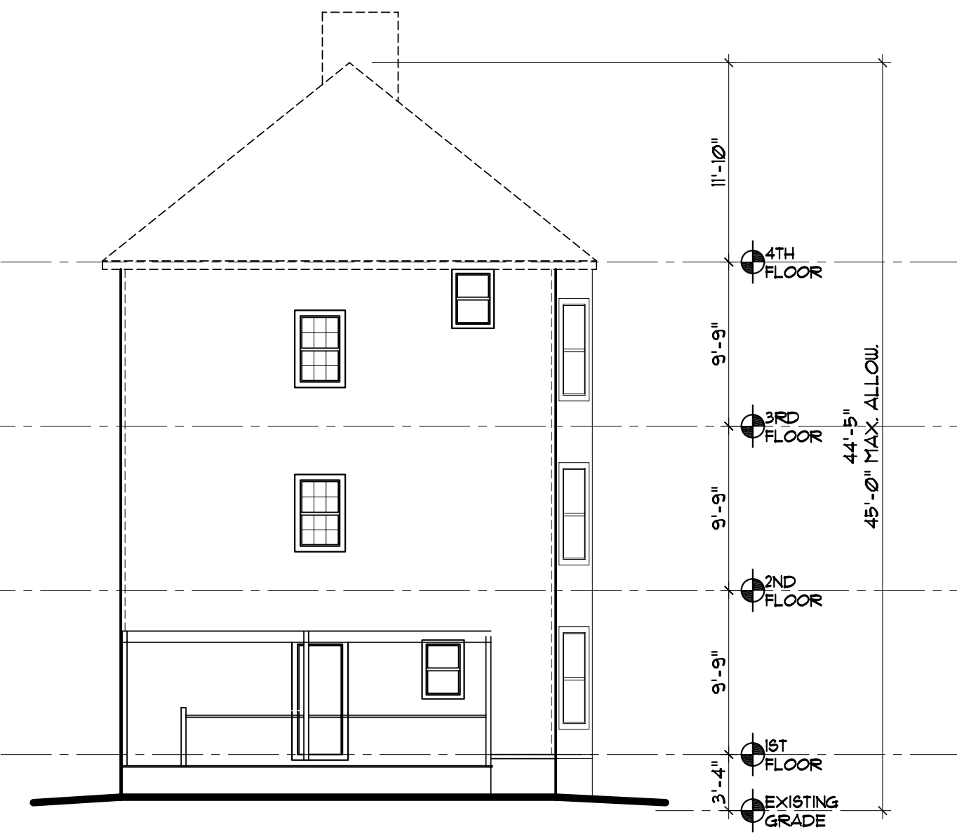
EXISTING REAR ELEVATION SCALE: 1/8" = 1'-0"
