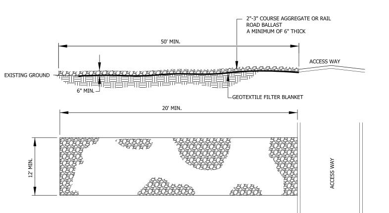
1. THE STABILIZED CONSTRUCTION ENTRANCE SHALL BE LOCATED WHERE TRAFFIC WILL ENTER OR LEAVE THE CONSTRUCTION SITE ONTO A PUBLIC STREET.
