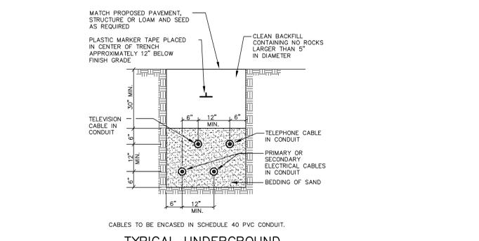
**TYPICAL UNDERGROUND CABLE INSTALLATION**
